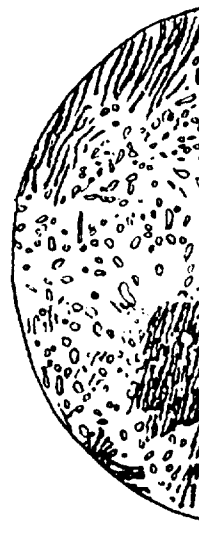
ЛА 9 пластинчатого перлита X500
